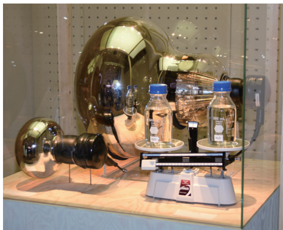
写真1：ノーベル博物館に寄贈されたスーパーカミオカンデで使用されている20インチ径および8インチ径光電子増倍管とSNO実験で使用された重水(D 2 O)および軽水(H 2 O)。
